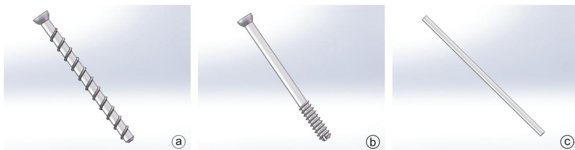
图1 内固定装置模型 a:全螺纹螺钉模型;b:半螺纹螺钉模型;c:克氏针模型
